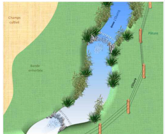
Après arasement de l'ouvrage
