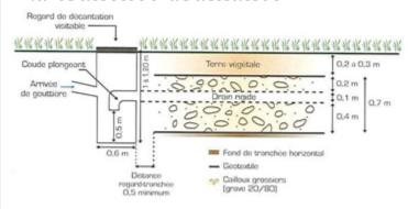
FONCTIONNEMENT : Une ou plusieurs tranchées remplies de matériaux granulaires (galets, graviers...) assurant la rétention du volume d'eau avant infiltration.
