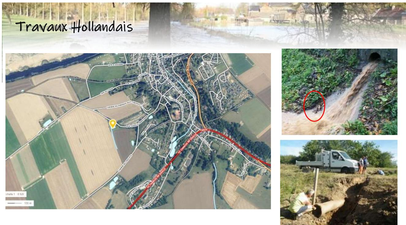
Lors des inspections de temps de pluie, des écoulements anormaux ont été observés à l'aval de l'ouvrage à la liaison entre la terre et le béton. Ceci est le signe qu'il existe un écoulement d'eau dans le corps de digue en lien avec une fuite. Des inspections non concluantes ont été réalisées en amont avec la mise à jour de la canalisation. A la suite d'un passage caméra il a été détecté une défaillance de certains joints entre les canalisations.
