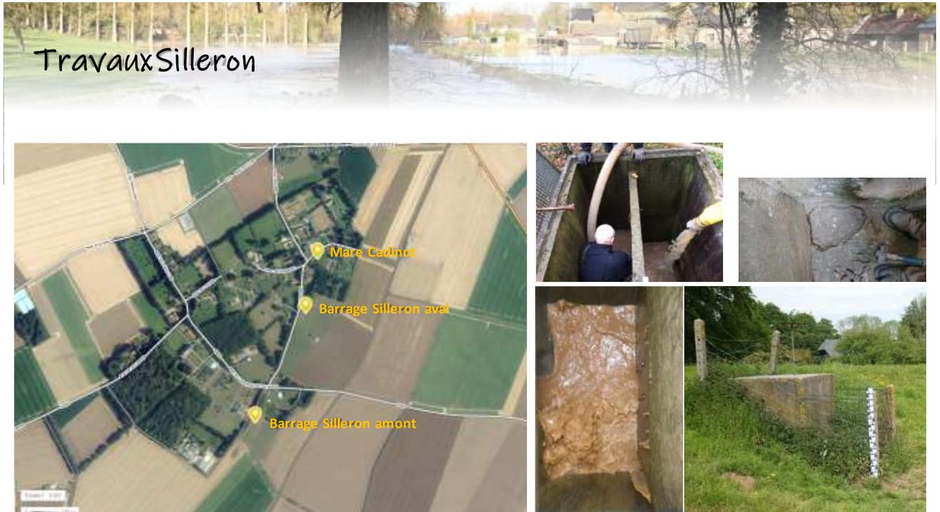
Il s'agit de 3 ouvrages en cascade. Les deux barrages se vident dans la mare Cadinot qui n'a aucun exutoire et qui se vide par infiltration. Il est donc nécessaire de réguler les débits qui arrivent dans cette mare. Il s'agit donc d'un cas particulier dans notre parc d'ouvrage où il est nécessaire de réguler les débits de fuite des ouvrages en jouant sur l'ouverture des vannes. Les dispositifs de fuite sont donc essentiels dans la protection du hameau d'Angiens.
